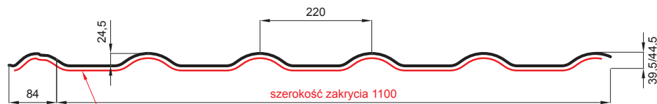
L – DŁUGOŚĆ OPTIMALNA POKRYCIA DLA MODUŁU 350 mm
