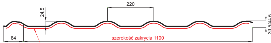
L – DŁUGOŚĆ OPTYMALNA POKRYCIA DLA MODUŁU 350 mm
