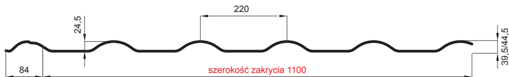
L – DŁUGOŚĆ OPTIMALNA POKRYCIA DLA MODUŁU 350 mm
