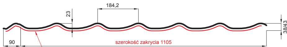
L – DŁUGOŚĆ OPTIMALNA POKRYCIA DLA MODUŁU 350 mm
