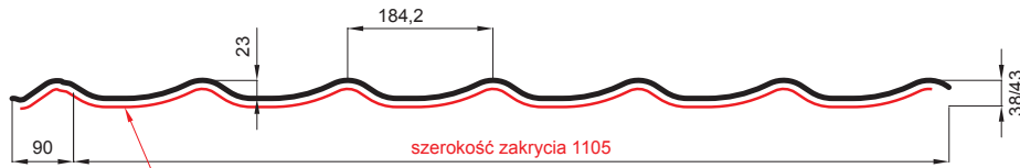
L – DŁUGOŚĆ OPTIMALNA POKRYCIA DLA MODUŁU 350 mm
