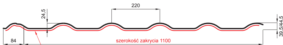
L – DŁUGOŚĆ OPTIMALNA POKRYCIA DLA MODUŁU 350 mm
