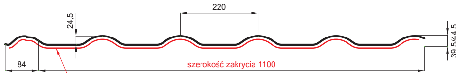
L – DŁUGOŚĆ OPTIMALNA POKRYCIA DLA MODUŁU 350 mm
