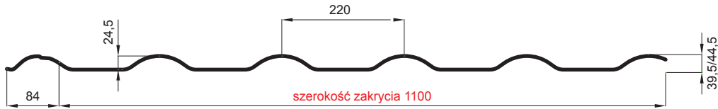
L – DŁUGOŚĆ OPTIMALNA POKRYCIA DLA MODUŁU 350 mm
