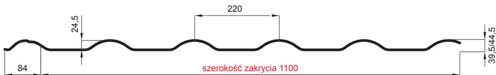
L – DŁUGOŚĆ OPTIMALNA POKRYCIA DLA MODUŁU 350 mm
