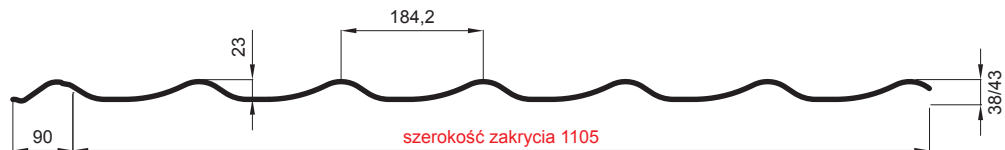
L – DŁUGOŚĆ OPTIMALNA POKRYCIA DLA MODUŁU 350 mm
