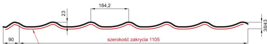
L – DŁUGOŚĆ OPTIMALNA POKRYCIA DLA MODUŁU 350 mm
