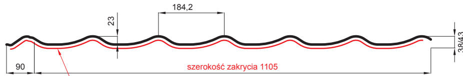
L – DŁUGOŚĆ OPTIMALNA POKRYCIA DLA MODUŁU 350 mm
