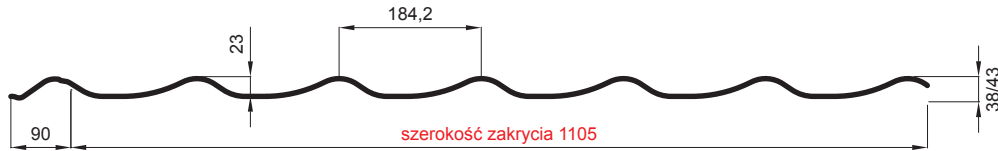
L – DŁUGOŚĆ OPTIMALNA POKRYCIA DLA MODUŁU 350 mm
